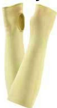
Manguito de filamento continuo, grosor de 24 galgas, forro de filamento continuo 100% Kevlar, longitud de 356 mm, abertura en el pulgar para una protección adicional en la zona de la muñeca.
