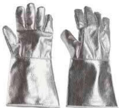
Palma y dorso en fibra de aramida aluminizada de 1,1 mm de grosor, forro en TNT ignífugo de 0,7 mm, manguito en tejido de aramida aluminizada con forro en TNT ignífugo, costuras con hilo de Kevlar.
