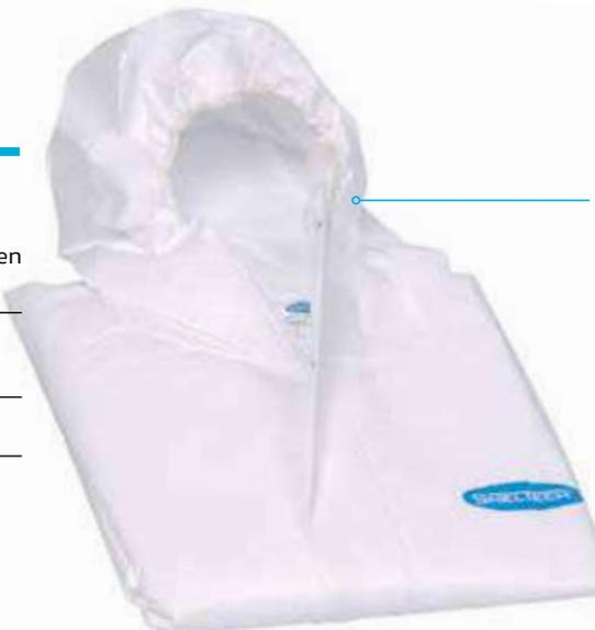
Prenda de protección realizada en material especial laminado, sin desprendimiento de partículas, con tratamiento antiestático, dotada de capucha con elástico, borde elástico en los puños más un elástico adicional para enganchar los pulgares, cremallera en la parte delantera con solapa cubrecremallera y tira adhesiva para asegurar un elevado nivel de hermeticidad contra los líquidos, puños y tobillos elásticos, elástico en la parte posterior de la cintura para una gran adherencia al cuerpo.
