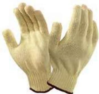
Guante de filamento continuo, grosor de 7 galgas, forro de Kevlar, revestimiento de Neptune, puño con labor de punto, longitud de 220-280 mm (según la talla).
