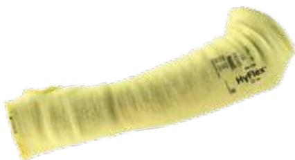
Manguito de filamento continuo, grosor de 24 galgas, forro de filamento continuo 100% Kevlar, longitud de 457 mm, abertura en el pulgar para una protección adicional en la zona de la muñeca.
