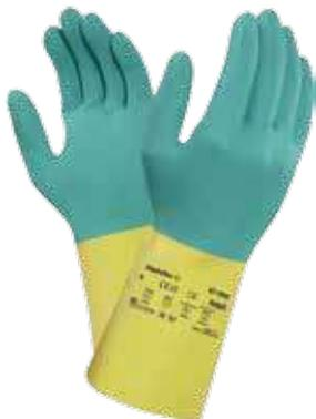
Guante de látex natural con mezcla de Neopreno para manipulación de sustancias químicas, grosor 0,68 mm, interior afelpado en algodón puro, tratamiento "Sanitized Actifresh", acabado exterior en relieve con rombos, óptimo agarre tanto en condiciones secas como mojadas, doble protección, longitud 323 mm.
