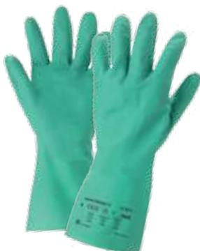
Guante de nitrilo para manipulación de sustancias químicas, completamente afelpado, grosor de 0,38 mm, óptima combinación de resistencia mecánica y contra agentes químicos, seguridad garantizada contra aquellos solventes empleados más a menudo, aceites, grasas, hidrocarburos alifáticos, ácidos, tratamiento Sanitized Actifresh, longitud 330 mm.
